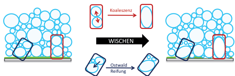
Abb. 3. Wischaktivität der Schaumblasen auf einer Glasplatte mit gefärbtem Öl (grün). Sie resultiert aus Ostwald-Reifung (Vergrößern und Verkleinern der Schaumblasen), Koaleszenz (Platzen der Schaumblasen) und dem anschließenden Neuordnen der Schaumblasen.
